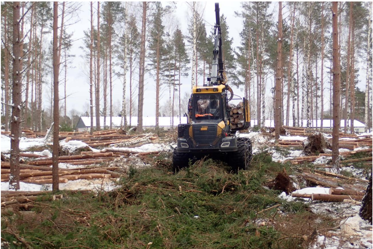
Bild: Uppredningsarbete efter stormen Alfrida. Risbädd används för att undvika hjulspår i landskapets mark.
